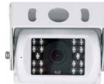
Backkamera 130° vidvinkel Blaupunkt RVC 3.0. Kraftfull backkamera med ljudmikrofon, värme, högupplösta 700 TV-linjer, högpresterande CCD-sensor och IP69K skyddshölje. För användning på kommersiella fordon och husbilar. 12V, PAL, IR-ljus. 2009019000001
