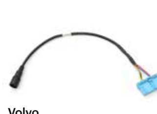
Volvo 30-pin kontakt för 1 st MXN-kamera utan elvisir till Volvo FH4/FM4 med Volvo A169 videoswitch. RV ADPVOLM
