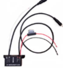
1 kamera, VW Till VW T6 och Crafter där en tidsfördröjning på trigger kan krävas. Behöver eventuellt kompletteras med RV ADPVWT6SHUT eller RV ADP23. Interfacet kan hantera en PWM signal som trigger, så ett powerswitch-relä behövs ej. RV IFVWT6CRAFT
