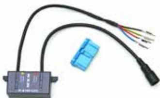
1 kamera, Plug & Play MXN-kamera med elvisir till Volvo FH4/FM4 med Volvo A169 videoswitch. RV IFA169CH
