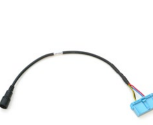
Adapterkabel Adapterkabel med 30-pin kontakt för 1 st MXN-kamera utan motoriserat visir till Volvo FH4/FM4 med Volvo A169 videoswitch. Art.nr RV ADPVOLM
