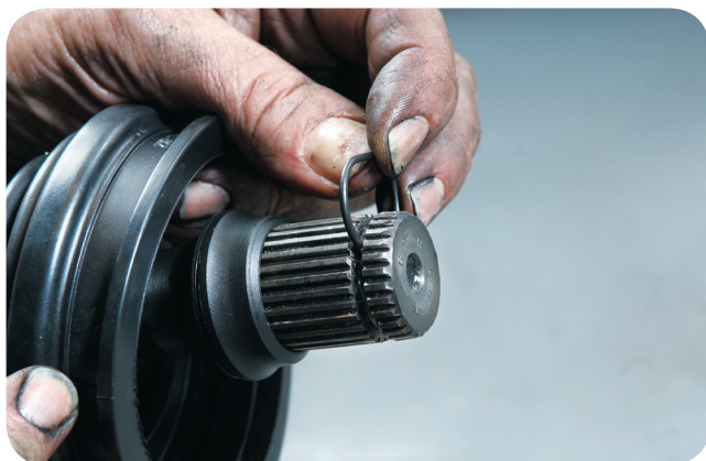
Bild 3: Den här bilden visar var låsringen sitter.
