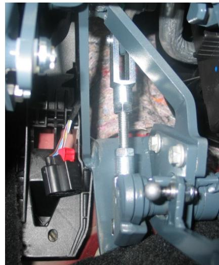
40. Placera originalgasmodulen, trä därvid på en plastbricka på bulten på gasmedbringaren och stick in bulten i slitsen på gasaxeln. Skruva fast gasmodulen igen.
