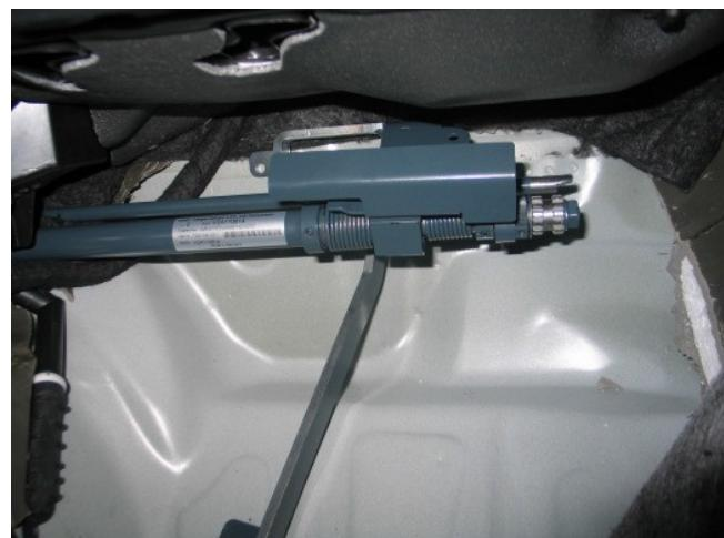
33.Rikta fästet så i sidled, att det inte uppstår någon axiell påfrestning på axlarna. Lägg an precis ovanför plåtkanten. Om det finns tätningsmedel här skall det tas bort.
