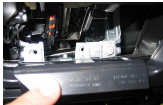
6. Skruva loss det vänstra luftröret och ta ut det.
