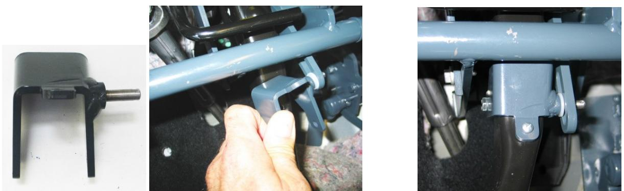
38.Komplettera medbringarbulten för bromsen med löprulle, plastbricka, fjäder och täckskiva och säkra med en sprint. Eventuellt måste avståndet i sidled mellan slitsen och medbringare justeras genom att böja slitsarmen något.
