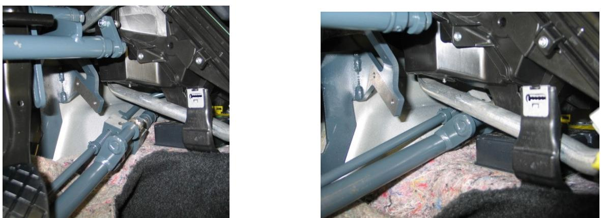
31.Skruta fast det vänstra lagerblocket på mittstycket från vänster på det vänstra fästet.
