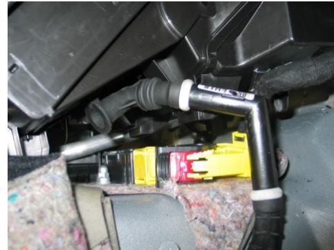
15.Skär av isoleringen på tvären på tunneln mellan airbagutlösningensheten och den främre väggen och ta ut den.
