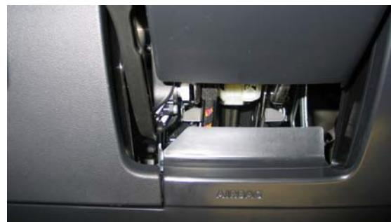
4. Skruva loss de främre sidoklädsslarna på mittkonsolen och dra ut dem nedåt.
