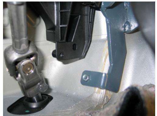
26. Lägg in det vänstra staget och skruva fast upptill med M8 x 40 mot fästet till rattstången.
