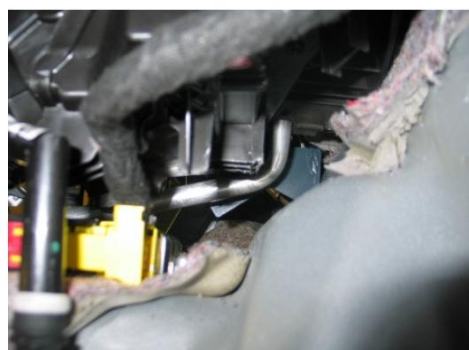
16.Skruga loss den nedre vänstra muttern M8 på bromskraftförstärkarfästet.
