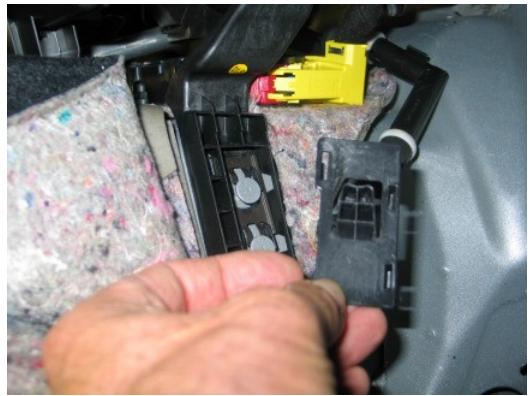
14.Dra av vattenavloppsslangen från höljet till värmekomponenten och lägg den inne till höger, så att den inte skadas när dubbelkommandot monteras.
