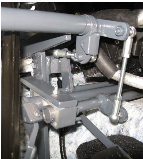
Hebelstellung bei Gasrückholung durch den Fahrlehrer
