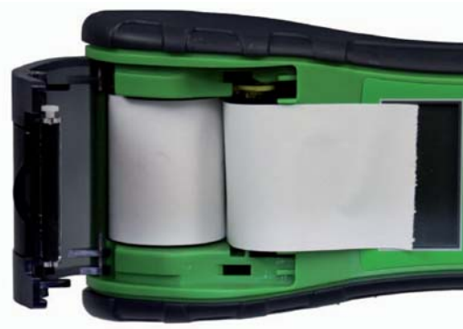
Fig. 4: Pappersmatningen sker från rullens undersida
