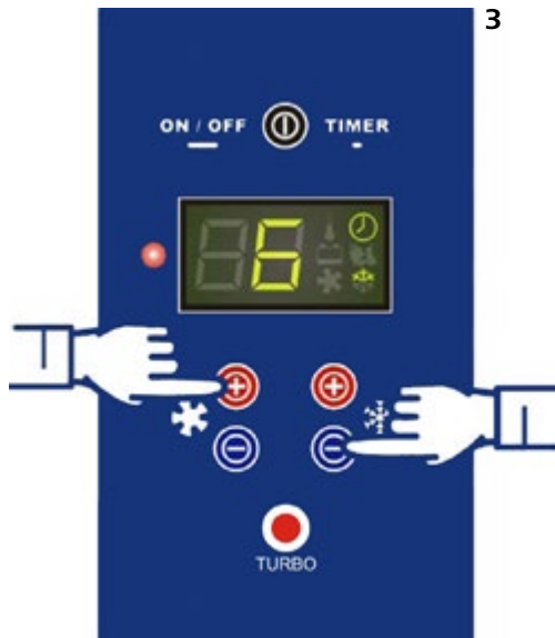
Variazione TIMER in modalità di funzionamento STANDARD TIMER adjustment in STANDARD mode Variation TIMER en modalit  STANDARD Einstellung TIMER in der Betriebsart STANDARD Variaci3n del TEMPORIZADOR en modalidad STANDARD
