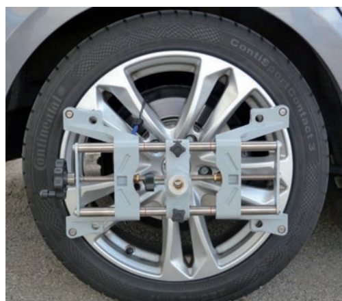
Fig. 19: Multi-Fit spännehållare monterad horisontalt
