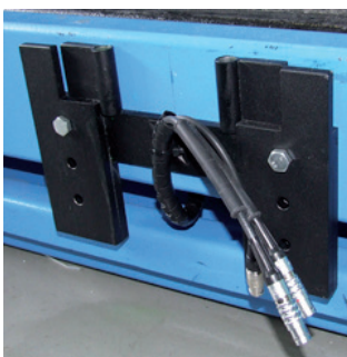
Fig. 16: Anslutningar för mätvärdessensorer
